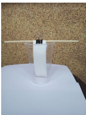
Рис.1. Прибор для проведения бумажной хроматографии
